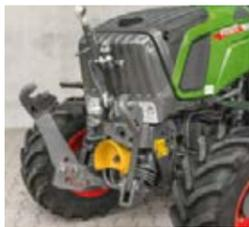
Uma capacidade de elevação de 2.540 daN está disponível no elevador frontal totalmente integrado na variante P. Depois, há o amortecimento de vibrações para que possa trabalhar com segurança e conforto.
