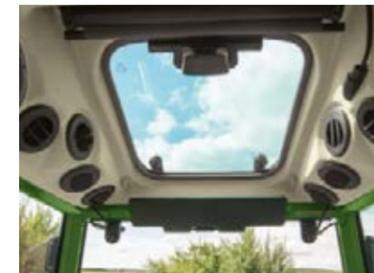
A janela do teto, integrada de série, oferece a melhor visibilidade para todos os tipos de trabalho suspenso. A janela superior pode ser aberta no sentido ascendente para ventilação da cabina. Uma proteção solar amovível protege-o contra a exposição solar intensa.
