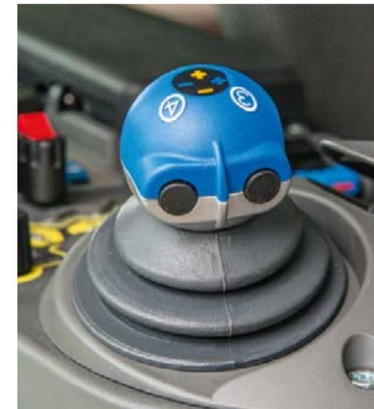
■ Os terceiro e quarto circuitos hidráulicos são convenientemente ativados através de um botão ou de um interruptor na alavanca monocomando em cruz elétrica.
