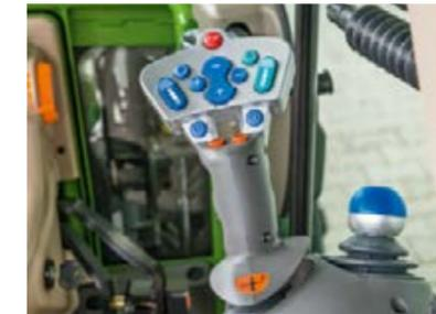
Quatro válvulas de duplo efeito no lado direito e duas válvulas no lado esquerdo, juntamente com o fluxo de retorno e conexão cruzada, permitem um ótimo fornecimento às combinações hidráulicas de alto nível. Podemos usar até 3 montagens ao mesmo tempo para combinações economizadoras de tempo e de custos.
