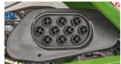
Filtro de elevado desempenho para uma capacidade de separação elevada sob condições difíceis.
