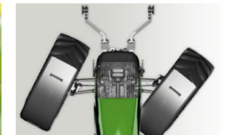
A função VarioActive permite-lhe alcançar um bloqueio da direção completo em apenas uma viragem.
