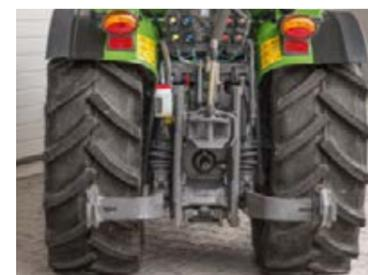
O elevador oscilante nas variantes V/F é ligado aos eixos frontal e traseiro. Os ganchos e os braços inferiores ajustáveis em largura permitem um ajustamento simples para corresponder a qualquer implemento.
