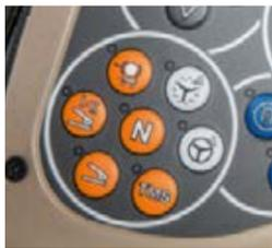
O sistema de direção sobreposta VarioActive e o sistema de Condução podem ser convenientemente ativados na consola do volante de direção.
