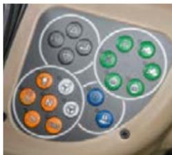
No painel de instrumentos, pode rápida e facilmente operar o monitor múltiplo, acionar confortavelmente as 4RM, o bloqueio do diferencial e a suspensão do eixo frontal assim como o Sistema de Gestão do Trator TMS.
