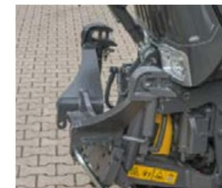
Os braços inferiores do sistema hidráulico frontal totalmente integrado podem ser dobrados de forma compacta em apenas alguns passos. O design compacto torna o 200 Vario particularmente manobrável, mesmo com um acessório frontal.
