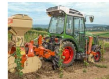
Montagem inter-eixo para um uso eficiente de combinações de implementos flexíveis.
