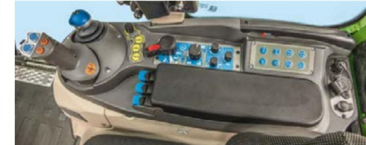
A consola da direção é ajustável em largura e é adaptada à sua posição de condução.
