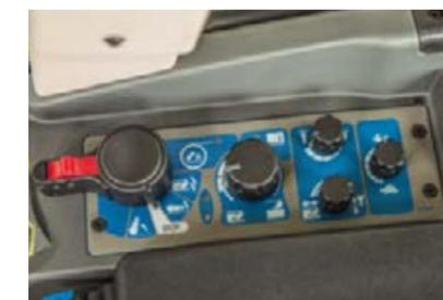
O elevador traseiro pode ser facilmente ajustável no painel de controlo EHR. O botão pode ser transferido para o joystick multifunções com a função automática.
