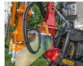
As placas de montagem integradas no elevador frontal proporcionam sempre uma base estável e segura para implementos pesados montados frontalmente.
