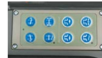
Pode controlar o ajustamento lateral e de inclinação do elevador oscilante, assim como balançar e bloquear, com a pressão de um simples botão. O mostrador de ajustamento de inclinação mostram-lhe sempre as configurações adaptáveis à sua aplicação.
