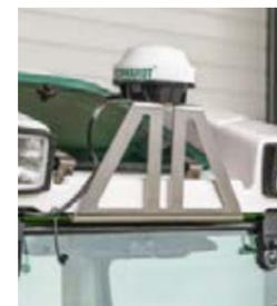
O sistema de condução GPS com base na posição fornece precisão de até 2 cm no Fendt200V/F/P Vario.
