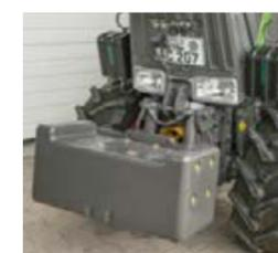
□ O peso frontal proporciona um melhor funcionamento do trem de potência no eixo frontal.
