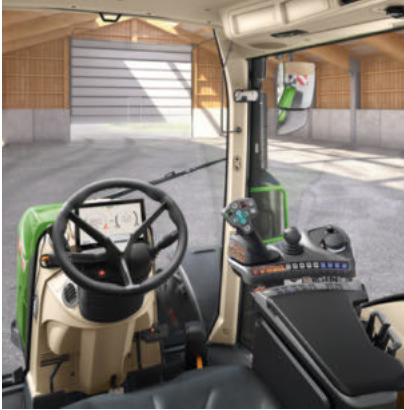
Power Setting 2 - Alavanca monocomando em cruz - Sem módulo linear (par de balancim)
