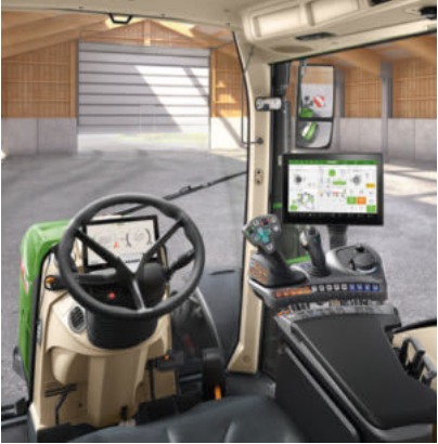
Profi Setting 2 - Joystick 3L - 1 módulo linear (par de balancim) para controlar distribuidores hidráulicos - Terminal de 12"
