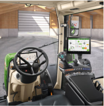
Profi+ Setting 1 - Alavanca monocomando em cruz - 1 módulo linear (par de balancim) para controlar distribuidores hidráulicos - Terminal de 12"
