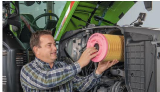
Um capô basculante e painéis laterais removíveis proporcionam excelente acesso ao compartimento do motor. Isso significa que pode remover o filtro de ar com rapidez e facilidade.
